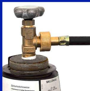
Ballonventil mit der **Hand** auf das Flaschenabsperrentil der Stahlflasche schrauben. Handrad des Flaschenabsperrentils an der Flasche öffnen. Bei Geradeausstellung des Schlauchstücks kann kein Gas ausströmen.
