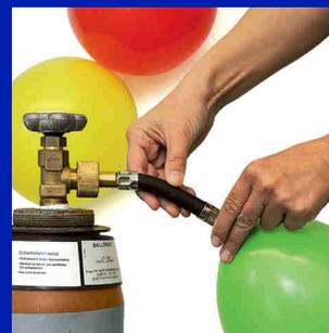
Nach Beendigung der Ballonfüllung zuerst Handrad des Flaschenabsperrentils an der Stahlflasche schließen und das Schlauchstück des Ballonventils nochmals abwinkel, damit das Restgas entweichen kann.
